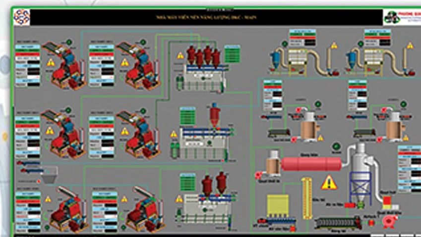
Giao diện SCADA
